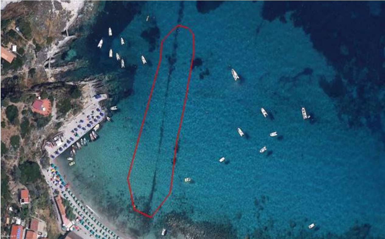
Figura 7 Condotta fognaria che intercetta l'asse dell'opera
